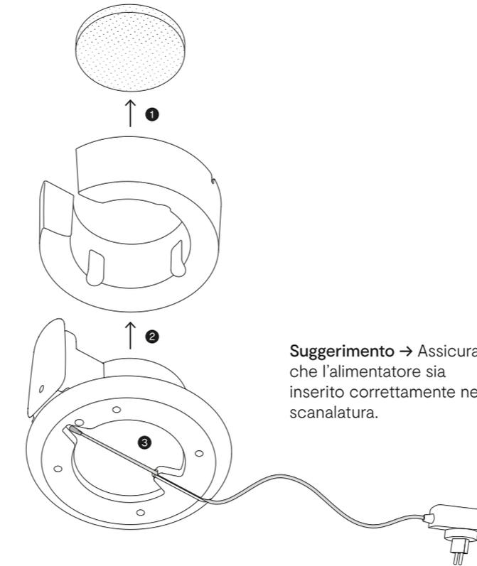
Rimuovi con attenzione il filtro ceramico ① e il serbatoio dell'acqua ② dalla base, capovolgila e collega l'alimentatore ③.
