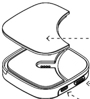
**Cover** → Removibile per la connessione di moduli extra.
