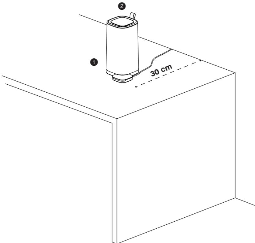
Le système Eteria peut être placé dans n'importe quelle pièce. Ne le place pas sur le sol, près de sources de chaleur ou dans des pièces à forte humidité. Nous recommandons de le placer à au moins 30 cm du mur. Ne pas obstruer l'entrée ① et la sortie ② d'air du purificateur. Pour obtenir des données précises, ne déplacez pas et n'éteignez pas le module de surveillance une fois qu'il a été positionné.
