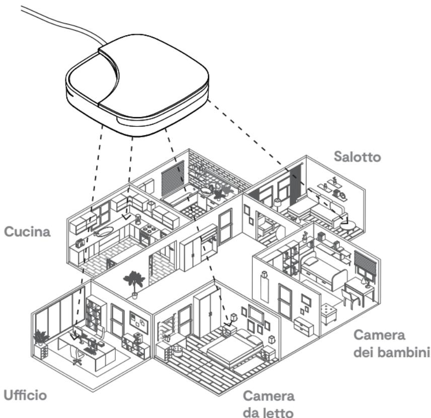
Il sistema Eteria è pensato per offrirti un'esperienza di purificazione e monitoraggio dell'aria diffusa in tutta la tua casa o ufficio. Posiziona almeno un modulo di monitoraggio in ogni stanza, in questo modo potrai controllare via app la qualità dell'aria in ogni tuo ambiente. Il purificatore può essere spostato sui vari moduli di monitoraggio.
