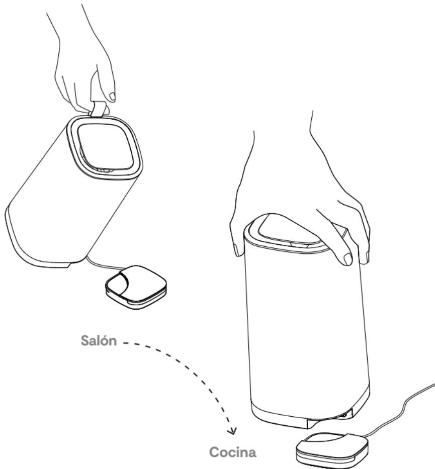
El purificador se activa mediante el módulo de monitorización. Si tienes más de un módulo de monitorización, mueve el módulo de purificación al módulo de monitorización que indique una mala calidad del aire, para poder purificar el aire donde sea necesario.
