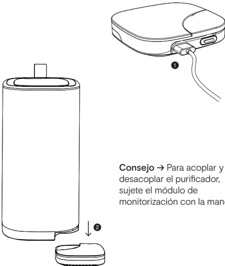
**Consejo →** Para acoplar y desacoplar el purificador, sujeté el módulo de monitorización con la mano.
