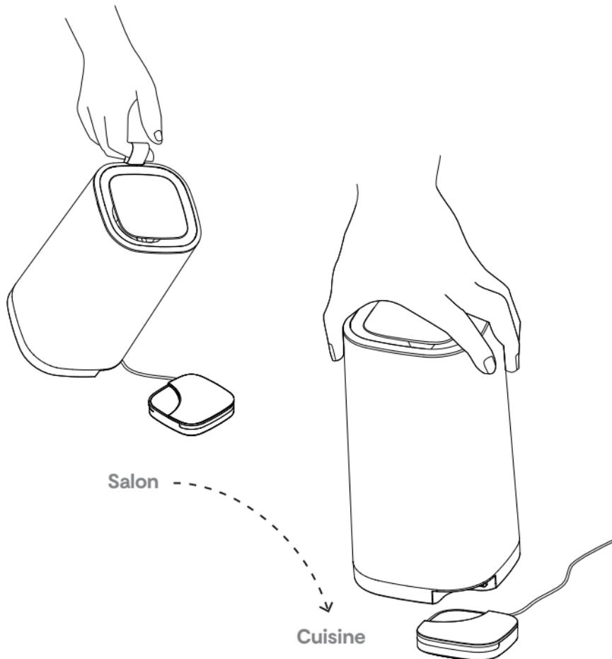
Le purificateur est activé grâce au module de surveillance. Si vous avez plus d'un module de surveillance dans votre espace, déplacez le module de purification vers le module de surveillance qui signale une mauvaise qualité de l'air, de cette façon vous pouvez purifier l'air là où il est nécessaire.
