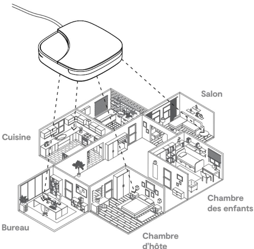
Le système Eteria est conçu pour vous offrir une expérience de purification et de contrôle de l'air étendue à toute la maison ou bureau. Placez au moins un module de surveillance dans chaque pièce, afin de pouvoir contrôler la qualité de l'air dans chacune de vos pièces via l'application. Le module de purification peut être connecté avec les différents modules de surveillance.
