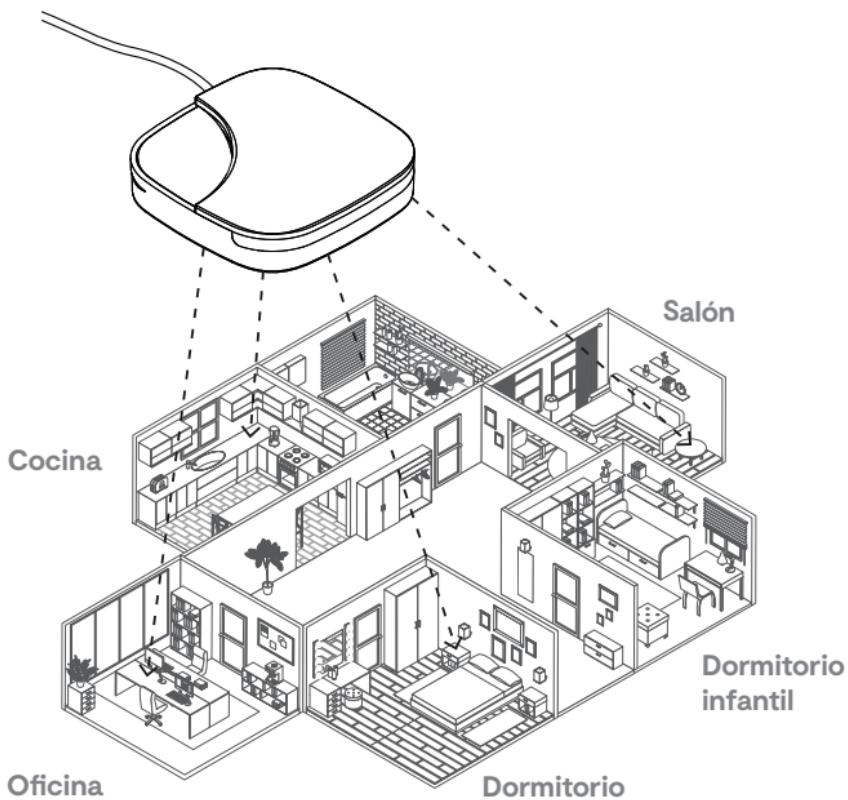
El sistema Eteria está diseñado para ofrecer una experiencia generalizada de purificación y control del aire en toda la casa u oficina. Coloque al menos un módulo de monitorización en cada habitación, para poder controlar la calidad del aire en cada una de ellas. El depurador puede ser trasladado a los diferentes módulos de monitorización.
