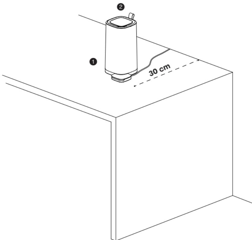
Das Eteria-System kann in jedem Raum platziert werden. Stellen Sie es nicht auf den Boden, in die Nähe von Wärmequellen und in Umgebungen mit hoher Luftfeuchtigkeit. Wir empfehlen, das Gerät mindestens 30 cm von der Wand entfernt aufzustellen. Versperren Sie nicht den Einlass- ① und Auslassbereich ② des Luftreinigers. Um genaue Daten zu erhalten, darf das Luftqualität Modul nach dem Platzieren nicht mehr bewegt oder ausgeschaltet werden.
