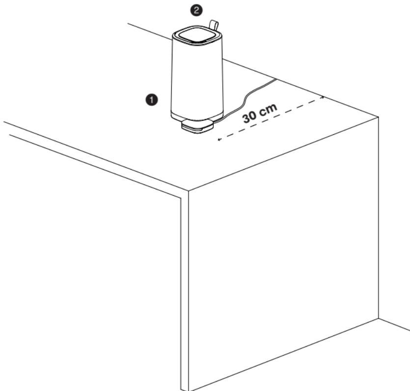
Eteria puede colocarse en cualquier habitación. No lo coloque en el suelo, cerca de fuentes de calor o en habitaciones con mucha humedad. Le recomendamos que lo coloque al menos a 30 cm de la pared. No obstruya la entrada ① y la salida ② de aire del purificador.
